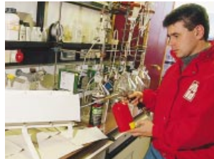
Die Befüllung wurde streng nach Herstellerangaben durchgeführt. Temperatur, Einfülldruck und Füllmenge müssen präzise stimmen
