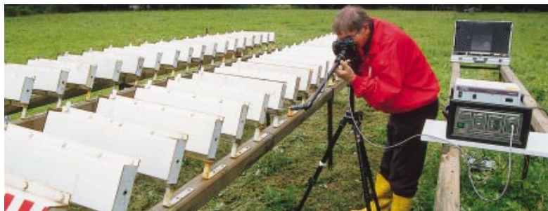
Alle sechs Monate untersuchte AUTO BILD-Sachverständiger Wolf Gudlat mit einem Storz-Endoskop die Testbehälter auf dem Freigelände der Uni Oldenburg
