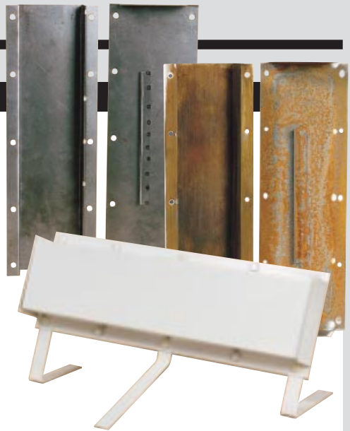
Links ein neuer Testkasten mit Winkelschiene. Daneben ein Kasten mit Oberflächenrost, fertig zur Montage und Befüllung. Unten der fertige Dauertestkandidat
